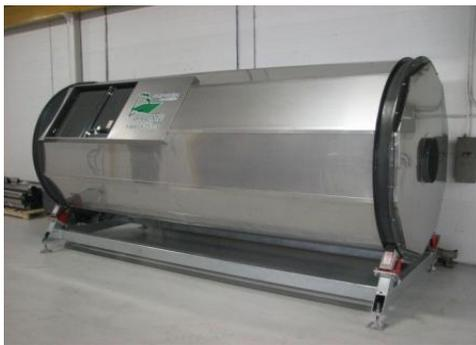
Figure 7: Système fermé de cylindre rotatif
