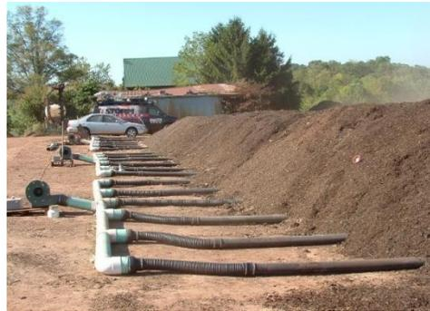
Figure 6: Système en andains statiques aérés
