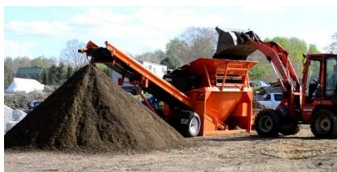
Figure 14: Tamis mécanique
